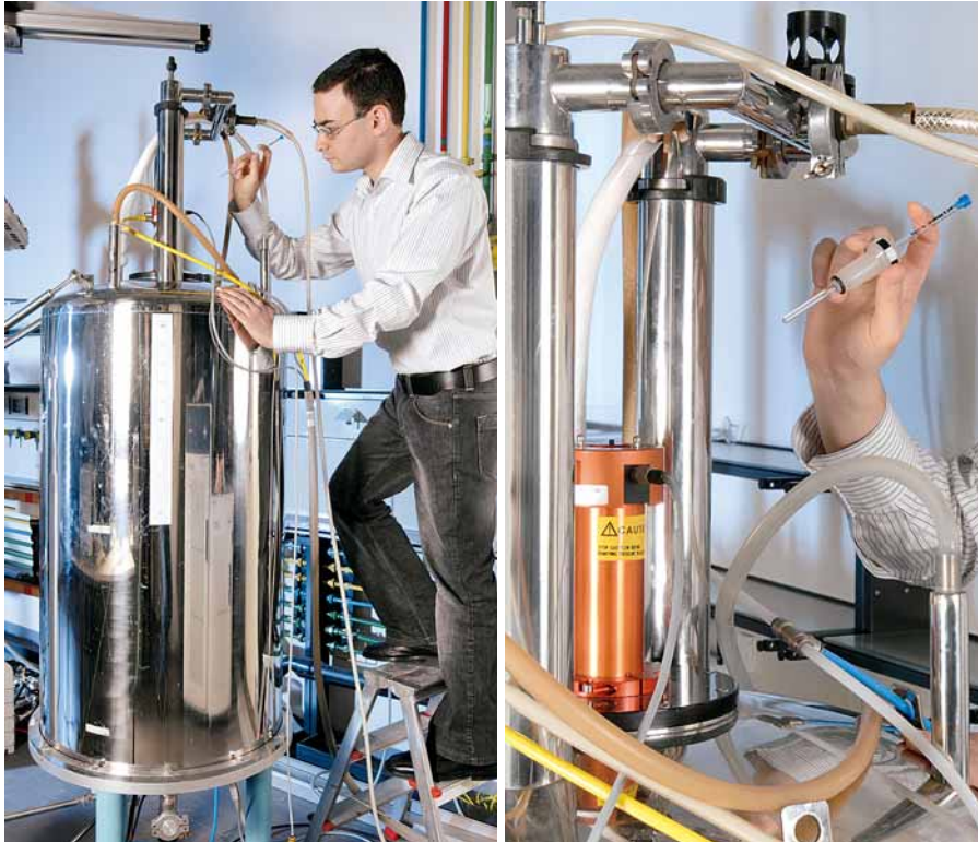
Qubits-Manipulation: Rodion Neigovzen bringt in Wasser gelöstes Natriumformiat in das Spektrometer ein.
